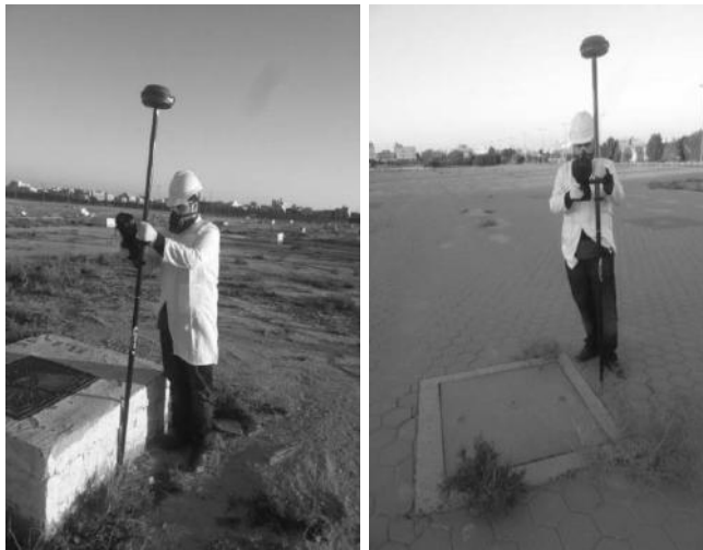
Fig. 3. Using GPS to log latitude and longitude data of boreholes
